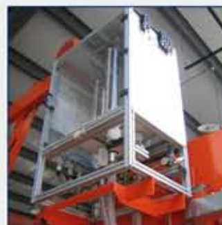
1 Конструкция смесительной площадки: Смеситель с весами для цемента и воды (как альтернатива дозирование воды через водяной счётчик), DWM – альтернатива HPGM с весами для льда, весами для химических добавок
