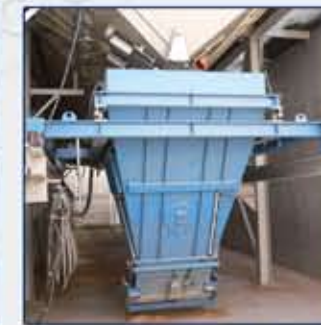
5 Взвешивание инертных материалов: весовой транспортёр подвешен в бетонном складе инертных материалов, Бетонный склад инертных материалов, конусы бетонного склада инертных материалов, передвижные весы – альтернатива весовому транспортёру
