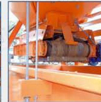
6 Дозирование в рядном складе: затворы для грубого-точного-дозирования, дозирующий транспортёр, вибратор с датчиком влажности «Hydrotester»
