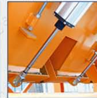
6 Дозирование в рядном складе: затворы для грубого-точного-дозирования, дозирующий транспортёр, вибратор с датчиком влажности «Hydrotester»
