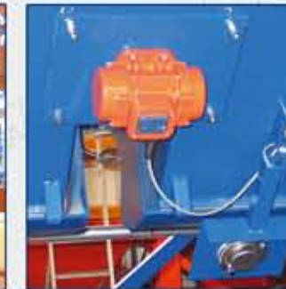
6 Дозирование в рядном складе: затворы для грубого-точного-дозирования, дозирующий транспортёр, вибратор с датчиком влажности «Hydrotester»
