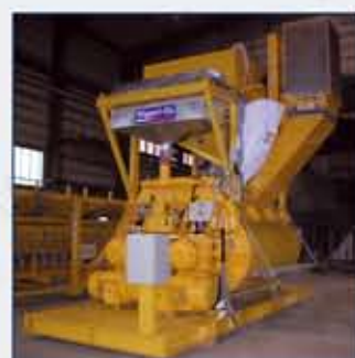
1 Конструкция смесительной площадки: Смеситель с весами для цемента и воды (как альтернатива дозирование воды через водяной счётчик), DWM – альтернатива HPGM с весами для льда, весами для химических добавок
