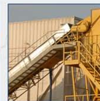
4 Загрузка смесителя: наклонный ленточный транспортёр, скиповый подъёмник
