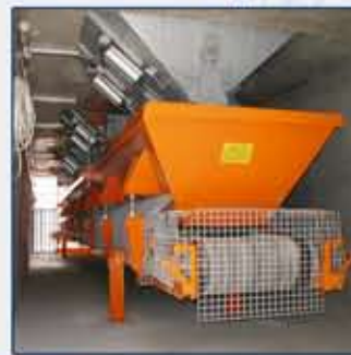
5 Взвешивание инертных материалов: весовой транспортёр подвешен в бетонном складе инертных материалов, Бетонный склад инертных материалов, конусы бетонного склада инертных материалов, передвижные весы – альтернатива весовому транспортёру
