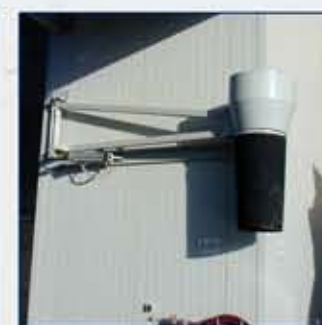
3 Выдача бетона: поворотная воронка для загрузки грузовых автомобилей, выгрузочный транспортёр
