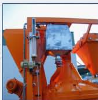
1 Конструкция смесительной площадки: Смеситель с весами для цемента и воды (как альтернатива дозирование воды через водяной счётчик), DWM – альтернатива HPGM с весами для льда, весами для химических добавок
