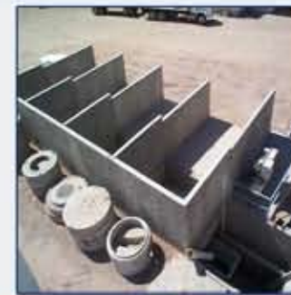
5 Взвешивание инертных материалов: весовой транспортёр подвешен в бетонном складе инертных материалов, Бетонный склад инертных материалов, конусы бетонного склада инертных материалов, передвижные весы – альтернатива весовому транспортёру
